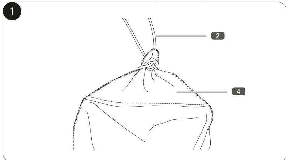
4. Öffnen Sie jeweils den Verschluss an den vier Ankersäcken und befüllen Sie die Ankersäcke mit reichlich feuchtem Sand, um die Ballastierung und Stabilität des Produkts zu gewährleisten.
