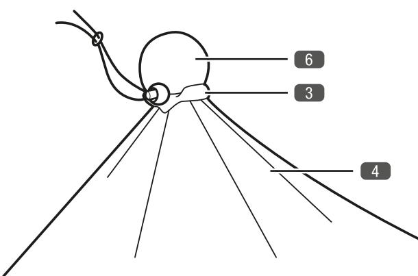
9. Wenn Sie mit dem Stand des Produkts zufrieden sind, befestigen Sie die Ankersäcke jeweils mit einem Bodenanker 5. Stecken Sie den Bodenanker durch die Schlaufe am Ankersack und dann bis zum Anschlag in den Boden (siehe Abb. 6). Achten Sie noch einmal darauf, dass die Leinen gespannt sind.
