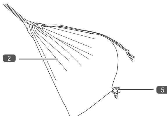
**i** Die Leinen an den Ankersäcken **2** können während der Nutzung nach Bedarf gekürzt werden, indem die Leinen, die durch die Ankersäcke führen, gezogen und mit dem Verschluss befestigt werden.
