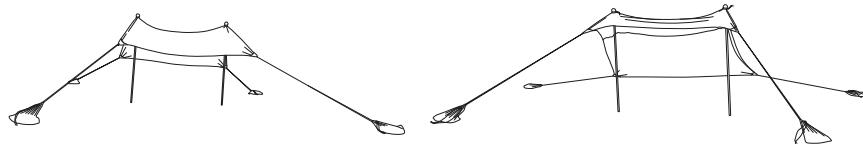
8. Befestigen Sie die Rohre mithilfe der Befestigungsschlaufen 3. Stülpen Sie dafür jeweils eine Befestigungsschlaufe über die Kugel und das Segeltuch und ziehen Sie den Verschluss fest zu (siehe Abb. 5).
