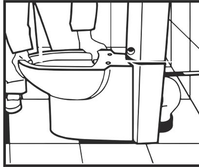
Anpassen und ausrichten der WC-Kombination. (Vorbereitung der Montage)
