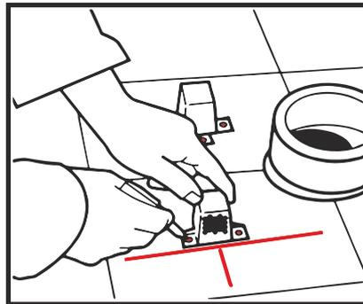
Anzeichnen und ausrichten des Befestigungssatzes. Achtung: Befestigungen um die Keramikstärke nach innen montieren. Zur leichteren Montage kann der Ablaufbogen auch noch einmal demontiert werden.
