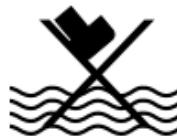
Evite que la batería entre en contacto con el agua. No tire la batería al agua. ¡Peligro de explosión!
