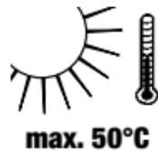
N'exposez pas la batterie à des températures supérieures à 50 °C.
